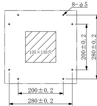
注) 1,長さを板金厚さに合わせたM4のビス8本で裏面から取付けます。
